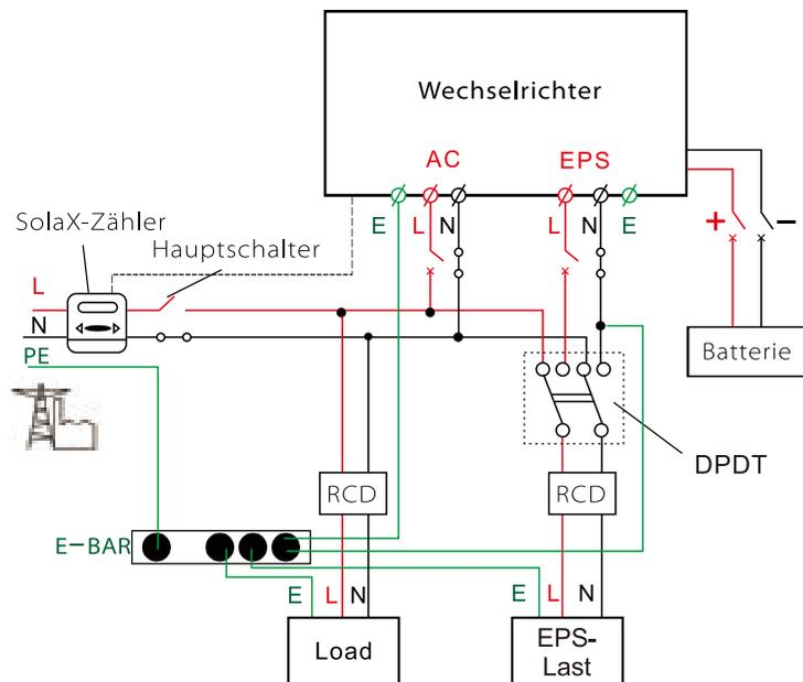
Die **Version I** ist für Verdrahtungsregeln vorgesehen, die erfordern, dass der Nullleiter der alternativen Versorgung NICHT isoliert oder geschaltet wird (entspricht den Verdrahtungsregeln AS/NZS\_3000:2012 für Australien und Neuseeland).
