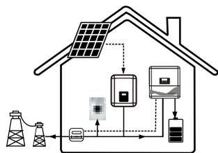
\*Sollte kein externer Generator vorhanden sein oder die Leistung nicht ausreichen, wird zunächst die Batterie für lokale Verbraucher entladen. Wenn die Batteriekapazität und Energieerzeugung nicht ausreichen, wird Netzstrom verwendet.
