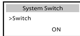
„System Switch“ kann auch durch langes Drücken der ESC-Taste „ON“ oder „OFF“ geschaltet werden.
